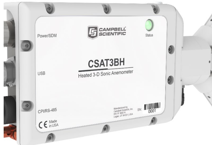
FIGURE 6-15. Lit status light on CSAT3BH block
